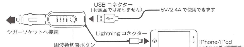
※本製品の電源スイッチはございません。本製品を車のシガーソケットに接続している状態では、常にFM電波を送信しています。ご使用にならない時には必ず、本製品をシガーソケットより抜いてください。
