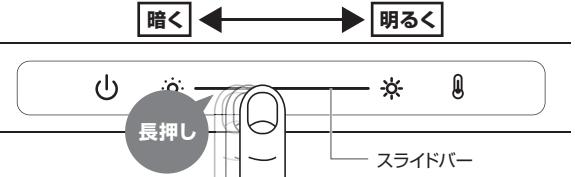
最高/最低の明るさにしたい時は、最高明るさ調節ボタン/最低明るさ調節ボタンをタッチすることで切替え可能です。
