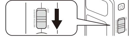
2.本製品をコンセントにしっかり差し込みます。フロントライトは消灯のまま、センサーが反応すると点灯します。
