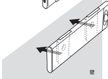
④ 製品を外して、さらにしっかり押しつけて壁にアタッチメントを固定します。
