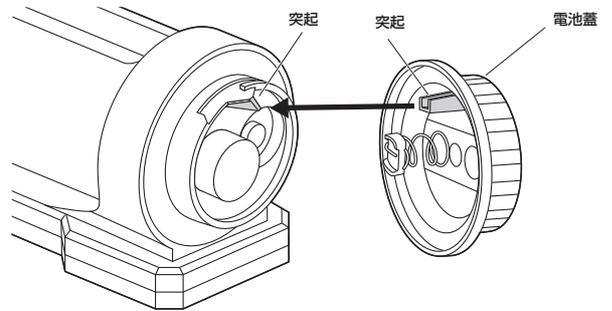
(4)電池蓋を矢印の方向に回してロックします。
