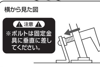
※同様にもう片方の脚部フレームも取付けます。
