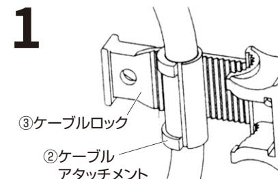
**800-BYSL003(8mmワイヤー)**の場合は、あらかじめ本体のワイヤー部分に②ケーブルアタッチメントを取り付け、ケーブルアタッチメント部分がケーブルロックのベルト部分にくるよう、セットします。
