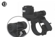
13 Halterung durch Hochziehen des Hebels freigeben. Das Band löst sich, die Halterung kann abgenommen werden.
