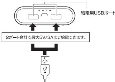
**1** 本体と、ご使用になる各機器に対応したUSBケーブルを用意し、本製品の各USBポートへ接続してご使用になる機器を充電します。
