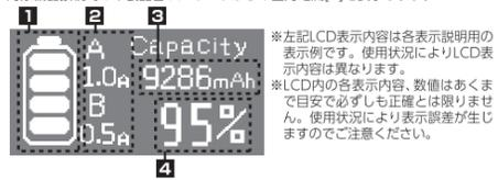
静電気などの影響により、LCDの各表示が正しく表示されない場合があります。その場合は、USB出力/LCD表示スイッチを約20秒間長押しする事でLCD表示がリセットされ、LCDの各表示が正しく表示される可能性があります。
