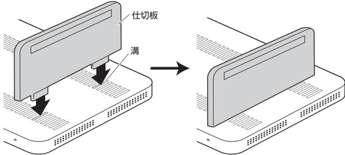
3 各機器の厚みに合わせて仕切板の位置を調整し、各機器を立てかけて使用します。
