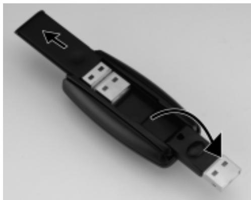
ポートに差し込み、ボタンを押しながら引き抜きます。
