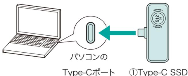
USBハブを経由してパソコンに接続する場合は、必ずセルフパワーモードで使用して、USBポートに電源が供給できる状態にしてください。
