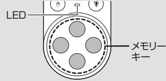
2 LEDが点灯中にお手持ちのリモコンのIRと本製品の上部を1~3cm程度離して、割り当てたいボタンを約2秒押ししてください。
