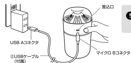
**Point** ケーブルを挿す時に、加湿器が倒れないように、手でしっかりと支えてください。
