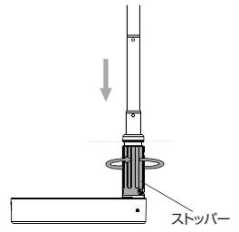
② ストッパーと羽根部を図のように倒します。
