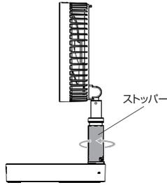
④ 羽根部を好きな位置に角度調節します。
