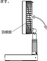
⑤ 伸縮支柱を引き上げて、高さを調節します。
