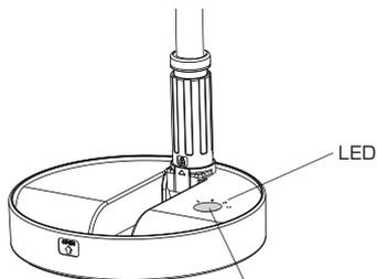
電源OFF状態以外で数秒経つと、LEDが全て点灯し、待機状態となります。再び電源ボタンを押すと、風量を変更できます。
