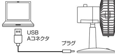
本製品に付属のUSBケーブルのプラグ側を挿してください。次にUSB Aコネクタ側をパソコンのUSBポートに接続してください。
