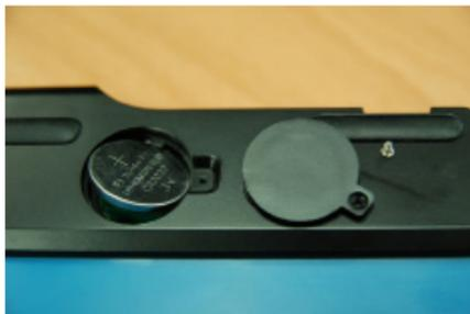
2. 新しいバッテリーを入れカバーを閉じてからネジを締めます。
