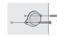
! 石膏ボードへの取付け時は、石膏ボード用のアンカーを別途ご用意ください。
