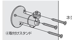
(2)カメラをスタンドに取付け、カメラ本体を手で固定した状態で、A、Bの順にスタンドをロックします。
