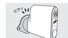
必ず壁の内部に芯材がある場所に設置してください。
