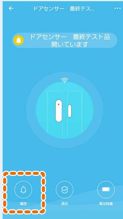
2 ドアを開閉した時間の履歴が表示されます。
