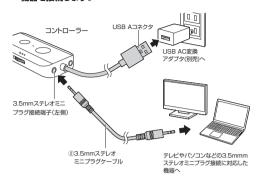
3.5mmステレオミニプラグ接続で使用する場合、必ず左側の3.5mmステレ オミニプラグ接続端子にケーブルを繋いでください。右側の端子に繋いでも 音楽や音声は流れません。
