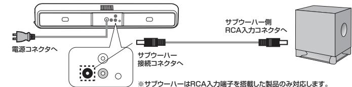
\*サブウーハーはRCA入力端子を搭載した製品のみ対応します。
