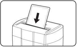
①普通に紙を細断するようにメンテナンスシートを1枚細断 してください。
