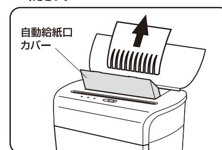
4. 自動給紙口カバーを閉めてから電源プラグをコンセント(100V)へ差し込みます。
