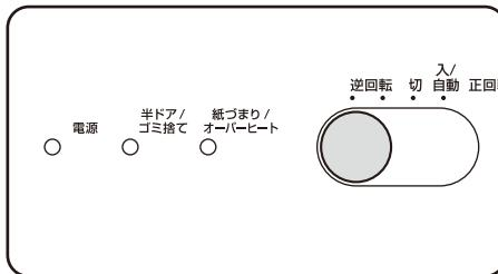
6. 電源スイッチを「正回転」に合わせ、正常に動作することを確認します。
