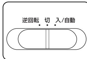
6. 電源スイッチを「切」にした後、必ず主電源スイッチの「○」を押し主電源をOFFにしてください。
