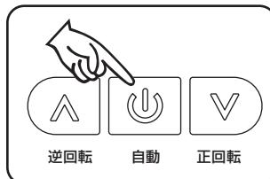
6. 「自動」ボタンを押した後、必ず主電源スイッチの「**○**」を押し主電源をOFFにしてください。
