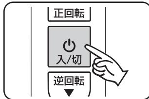
6. 「入/切」ボタンを押した後、必ず主電源スイッチの「○」を押し主電源をOFFにしてください。
