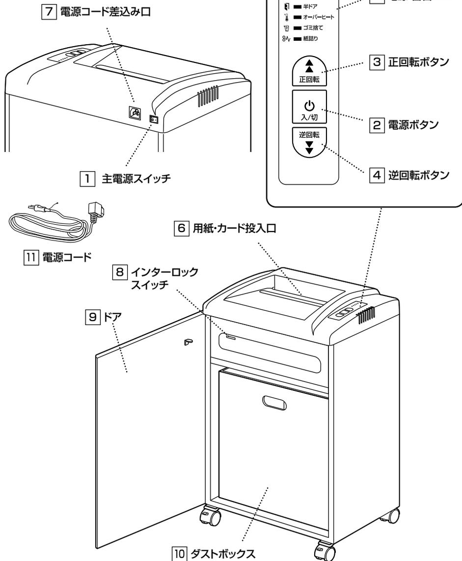
**注意** 必ずコンセントに近く、電源プラグを容易に取外しできる場所に本体を設置してください。
