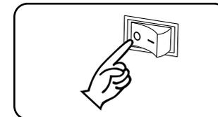
1. 主電源スイッチの「O」を押してOFFにし、電源LEDが消灯していることを確認してください。
