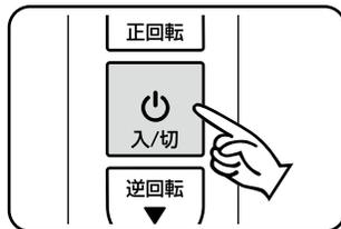
6. 「入/切」ボタンを押した後、必ず主電源スイッチの「O」を押し主電源をOFFにしてください。
