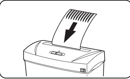
3. 終了後は、必ず運転スイッチを“切”に合わせ、電源スイッチをOFF(「○側」を押す)にして電源プラグを抜いてください。
