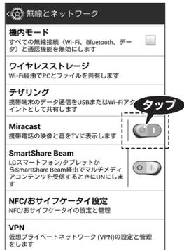
③プロジェクター側が「アンドロイド接続設定」になっていることを確認してください。スマートフォン上に「SANWA-\*\*\*\*\*」と表示されますのでこの部分をタップします。(\*の部分は製品により異なります)
