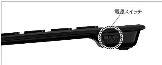
(2)電源をOFFにする場合は、電源スイッチをOFF側へスライドします。
