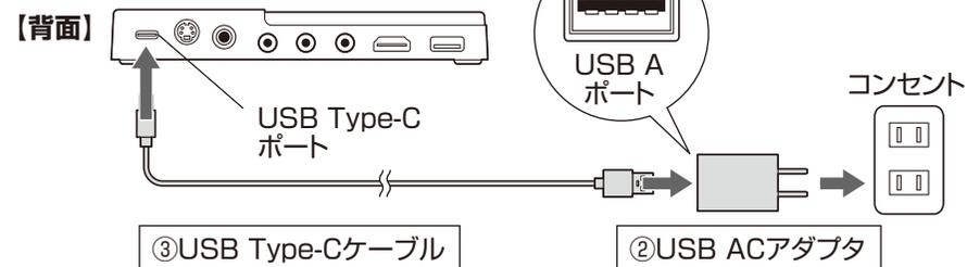
本製品はバッテリーを内蔵しているため、充電すれば給電せず使用できます。
