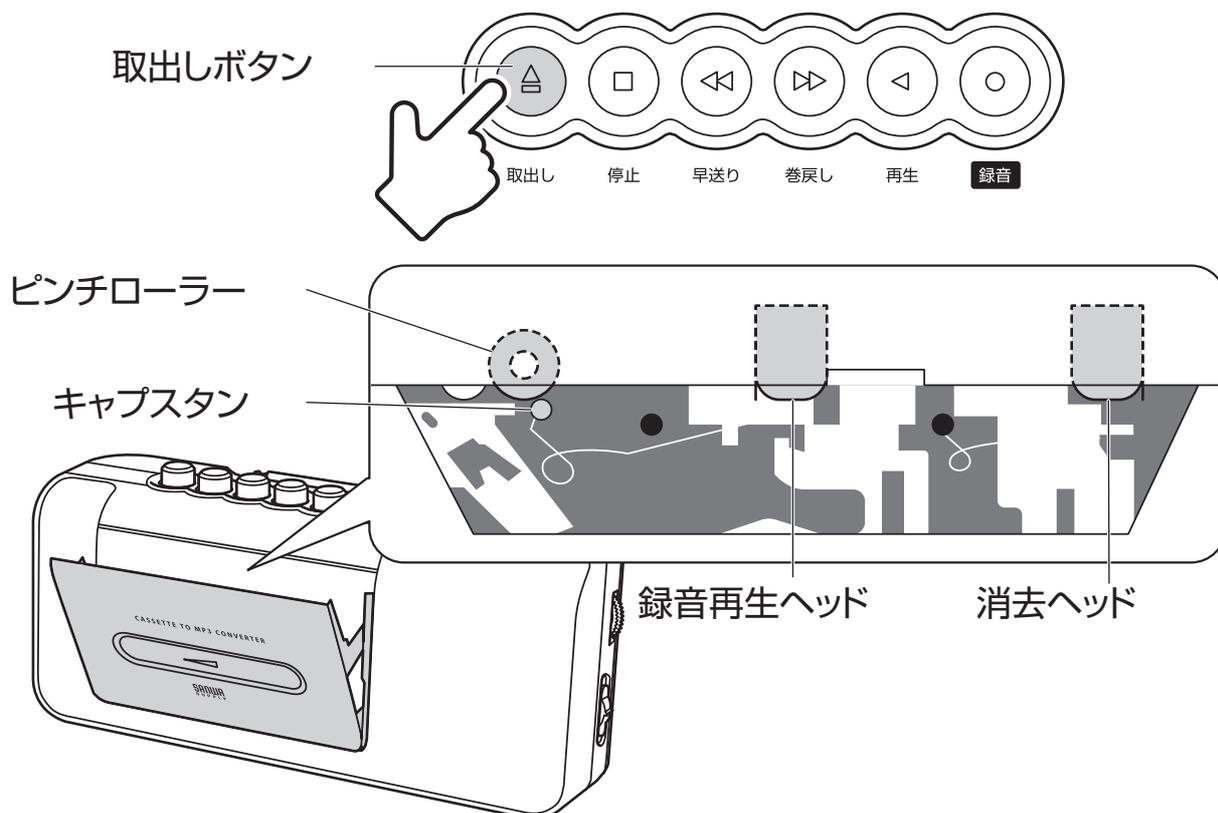
ヘッドの消磁を行うには市販の消磁器をご使用ください。カセットタイプの消磁器をご使用になる時は、必ず再生ボタンのみを押し込んで消磁してください。詳しくはヘッド消磁器の説明書をご覧ください。
