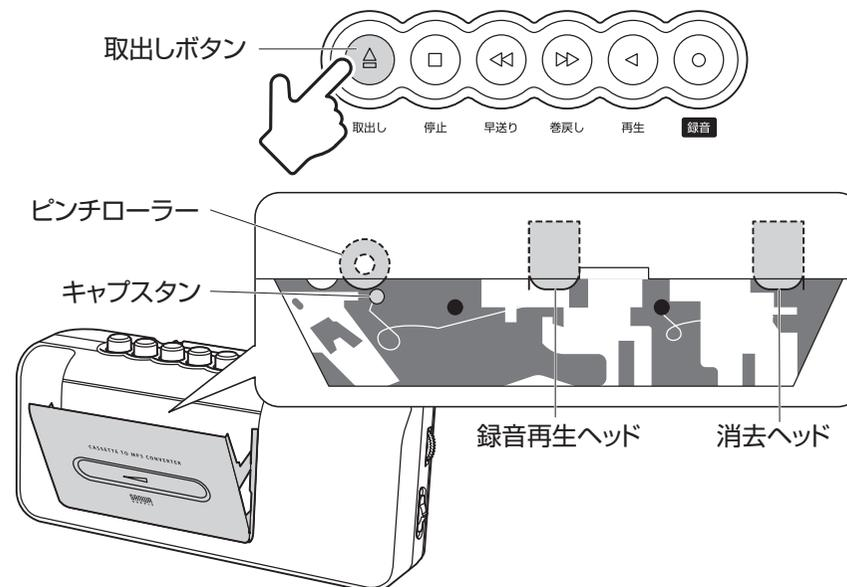
ヘッドの消磁を行うには市販の消磁器をご使用ください。カセットタイプの消磁器をご使用になる時は、必ず再生ボタンのみを押し込んで消磁してください。詳しくはヘッド消磁器の説明書をご覧ください。
