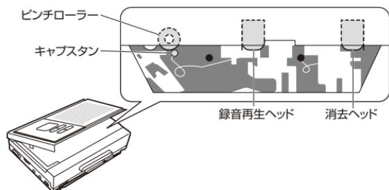
ヘッドの消磁を行うには市販の消磁器をご使用ください。カセットタイプの消磁器をご使用になる時は、必ず再生ボタンのみを押し込んで消磁してください。詳しくはヘッド消磁器の説明書をご覧ください。
