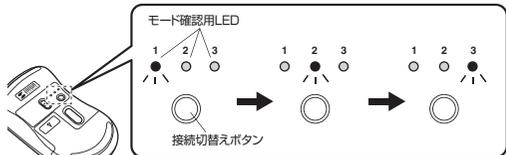
2.接続切替ボタンを長押ししてください。モード確認用LEDが点滅します。
