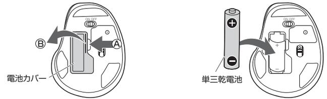
1 乾電池の保護フィルムを剥がしてから入れてください。保護フィルム
