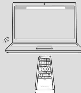
**2** 左・右ボタンをLEDが点灯するまで同時に押します。LEDが点灯したら、左・右ボタンを離します。2、3秒でLEDの点灯が消えると、リセット完了です。
