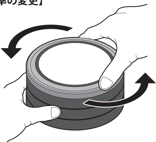
②図のように本体側面をしっかりと固定し、レンズ部分を反時計回りに回転させてください。
