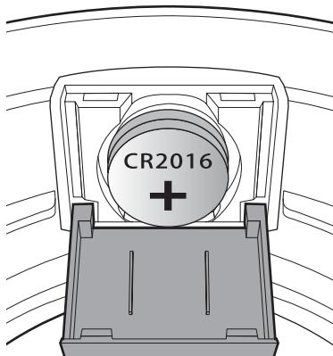
②電池の向きを確認し、電池ボックスに新しい電池を挿入してください。挿入後、カバーを戻し電池ボックスを閉じてください。
