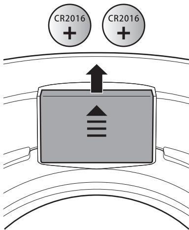
①カバーを矢印の方向へスライドさせ、電池ボックスから古い電池を取り出してください。
