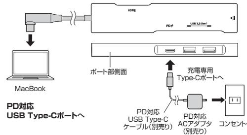
△ ※必ずパソコン本体に付属のACアダプタか、PD対応のACアダプタを接続してください。45W以上のACアダプタ推奨です。
