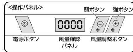
※風量確認パネルでファン回転数(風量の強さ)を確認できます。ファン回転数は800～3500RPMまで変更可能です。
