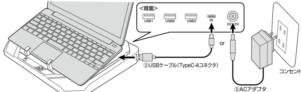
④操作パネルの電源ボタンを長押ししてONにしてください。
