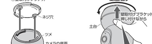
① カメラが壁取付けブラケットにしっかり固定できているか確認してから、カメラから手を離してください。
