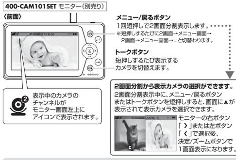
① 増設用カメラをペアリング中にカメラが接続されていない、もしくは通信範囲外の場合、増設用カメラのモニター画面はOFFになります。その場合画面警告アイコン がモニターに表示され、1秒ごとにピー音が鳴ります。増設用カメラが電源ONの状態でもモニターを近づけることで接続されます。
