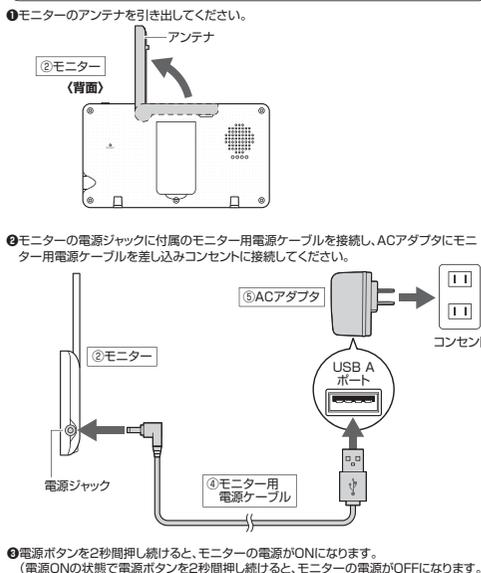
電源ボタンを2秒間押し続けると、モニターの電源がONになります。(電源ONの状態では電源ボタンを2秒間押し続けると、モニターの電源がOFFになります。)
