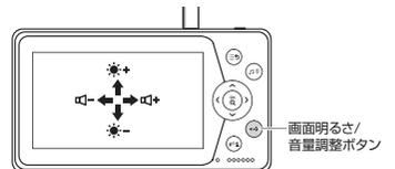
上ボタン「へ」または下ボタン「へ」を押すことで明るさを調整できます。左ボタン「>」または右ボタン「<」を押すことで音量を調節できます。画面明るさ/音量調整ボタンをもう一度押すと終了します。
