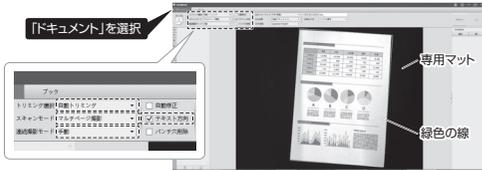
②書類の周りの緑の線で自動的にトリミングされますが、もし書類と緑の線の隙間がある場合は、ツールバーの「手動トリミング」を選択してください。緑の線の角を引っ張ってトリミング位置を調整してください。
