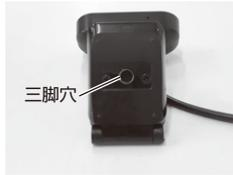
スタンド裏面の三脚穴に、三脚のカメラネジを取付け可能です。
