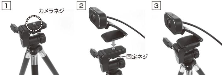
スタンド裏面の三脚穴に、三脚のカメラネジを取付け、固定ネジをまわして固定します。
