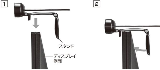
本製品を液晶ディスプレイにのせます。ディスプレイの厚みに合わせて、スタンドを動かしてディスプレイを挟み込み、設置します。
