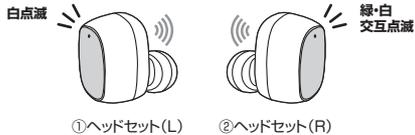
②接続したい機器(スマートフォンなど)のBluetooth設定をONにして、Bluetooth機器の表示リストから「400-BTTWS3BK」を選択します。
