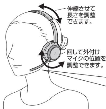
付属の外付けマイクをヘッドセットのマイクジャックに取付けて使用すれば、マイクを口に近づけることができ、通話が安定します。
