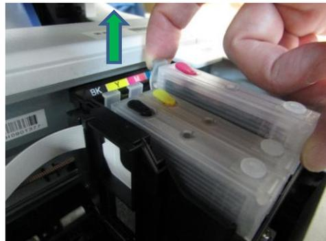
カートリッジ内にインクが残っている場合もございますが、そのままプリンタには戻さず、詰め替え手順①から作業を行い必ずインクを注入してください。
