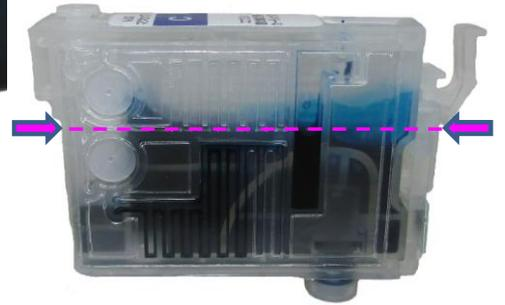
③注入口周りのインクをペーパータオル等で拭き取り、空気口に差していたプラグをインク注入口にしっかりと差し込みます。(差し込みが不完全な場合、印字不良の原因となります。)
