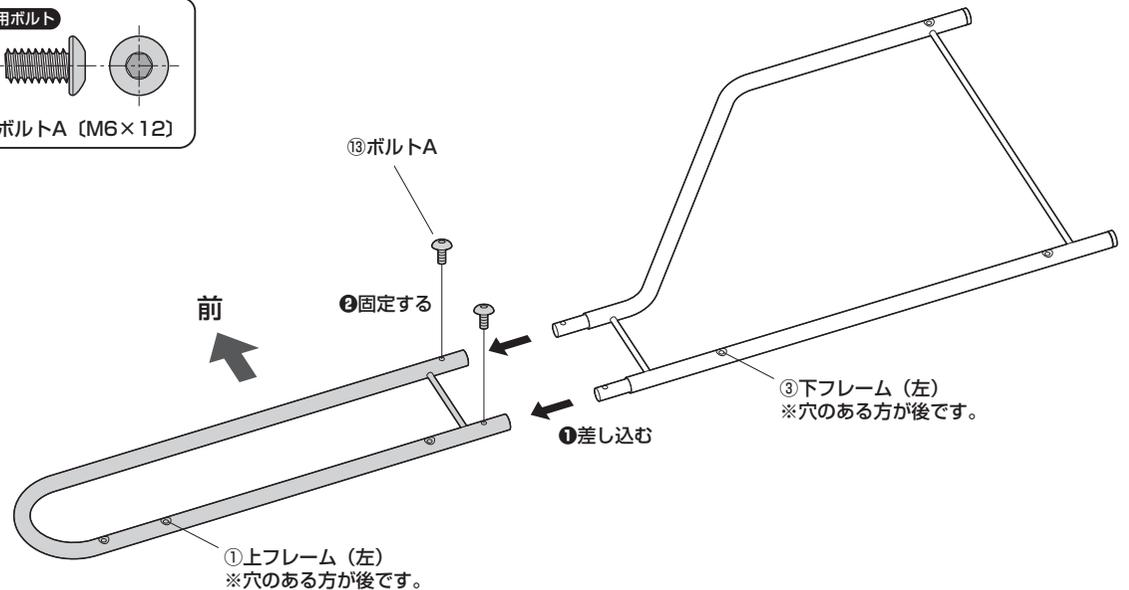
※同様に下フレーム(右)にも上フレーム(右)を取付けます。
