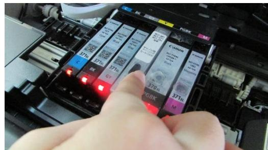
これで作業完了です。クリーナーカートリッジをプリンタへ装着したまま、1日~2日放置してください。(この間プリンタ電源は OFF で構いません。)時間経過後、クリーナーカートリッジを取り外して、インクの入っているカートリッジを装着。クリーニング・ノズルチェックで印字状態を確認してください。
